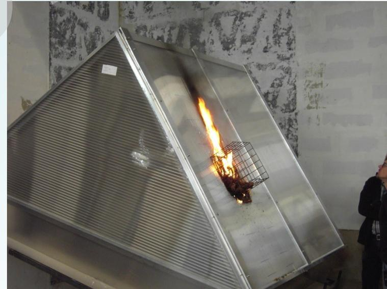
Probekörper dreieckiges Dachlichtband: Prüfung bestanden bis 20° Flachdacheinbau
